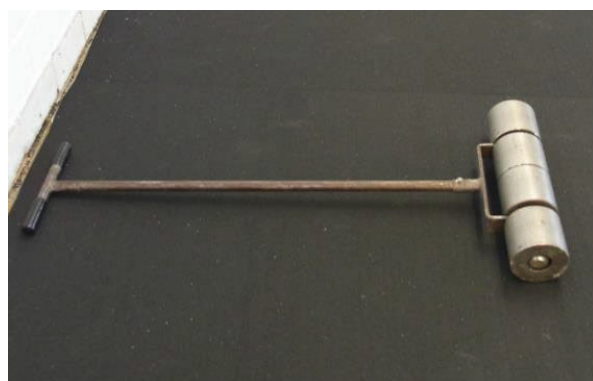
Rol de luchtballen onder de vloer weg met een roller
